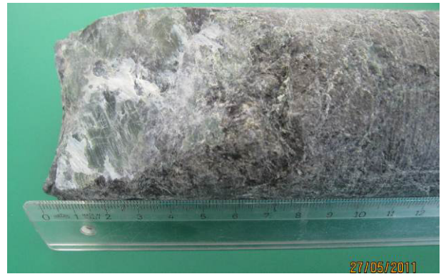
Bild 6: Bohrkern mit glatter Bruchfläche
