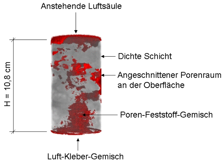
Abb. 4-7: Ansicht einer Neutronen-Computer-Tomographie des Prüflings 15A mit Erläuterungen.
