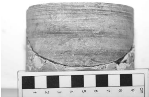
Abb. 5-2: Unverhältnismäßig grobes Korn des Zuschlags aus Jettenbach
