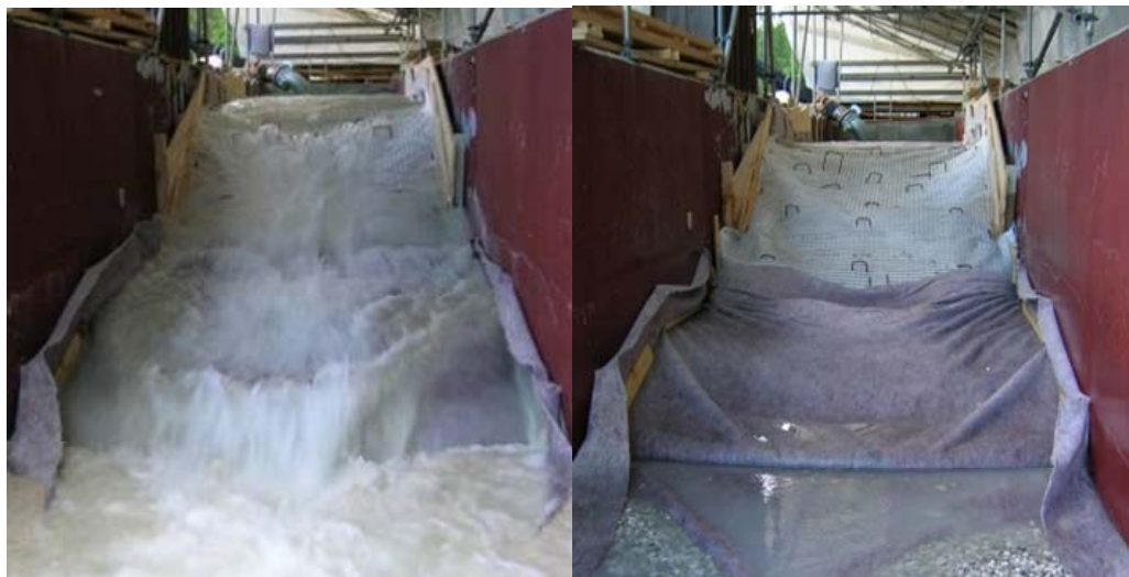
Abbildung 4.5-1 Aufbau von Versuch 15 mit Deichhinterweg und Böschungssicherung mit Erdnägeln
