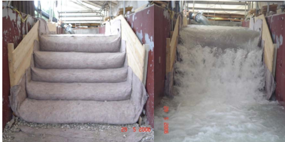
Abbildung 4.4-2 Versuch 05 vor/nach Überströmung (links), während Überströmung (rechts)
