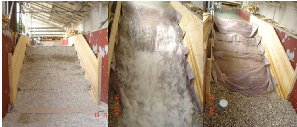
Abbildung 4.3-2 Versuch 07 vor Überströmung (links), während Überströmung (mittig), nach Überströmung (rechts)
